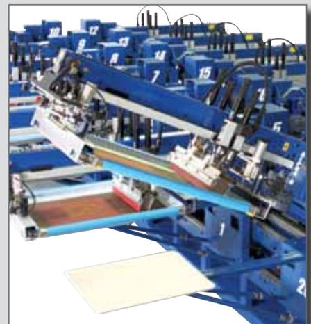
**El modo de elevación alta de los cabezales de impresión simplifica la carga del marco, la descarga, la inspección y la limpieza**
